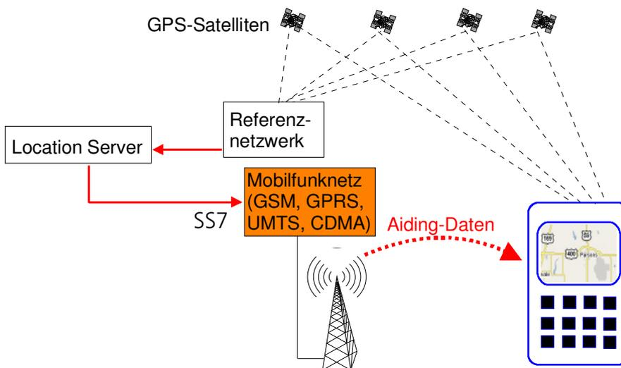
**Bild 127: Bei der Control-Plane Architektur muss das Mobilfunknetz geändert werden.**
