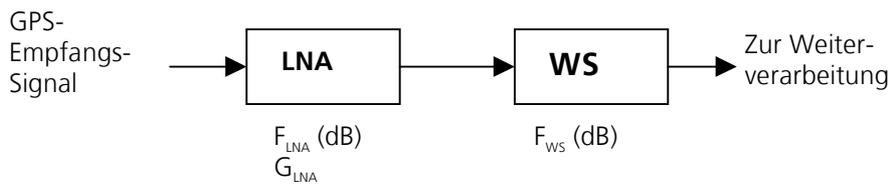
**Bild 130: Blockschaltbild der Eingangsstufe**
