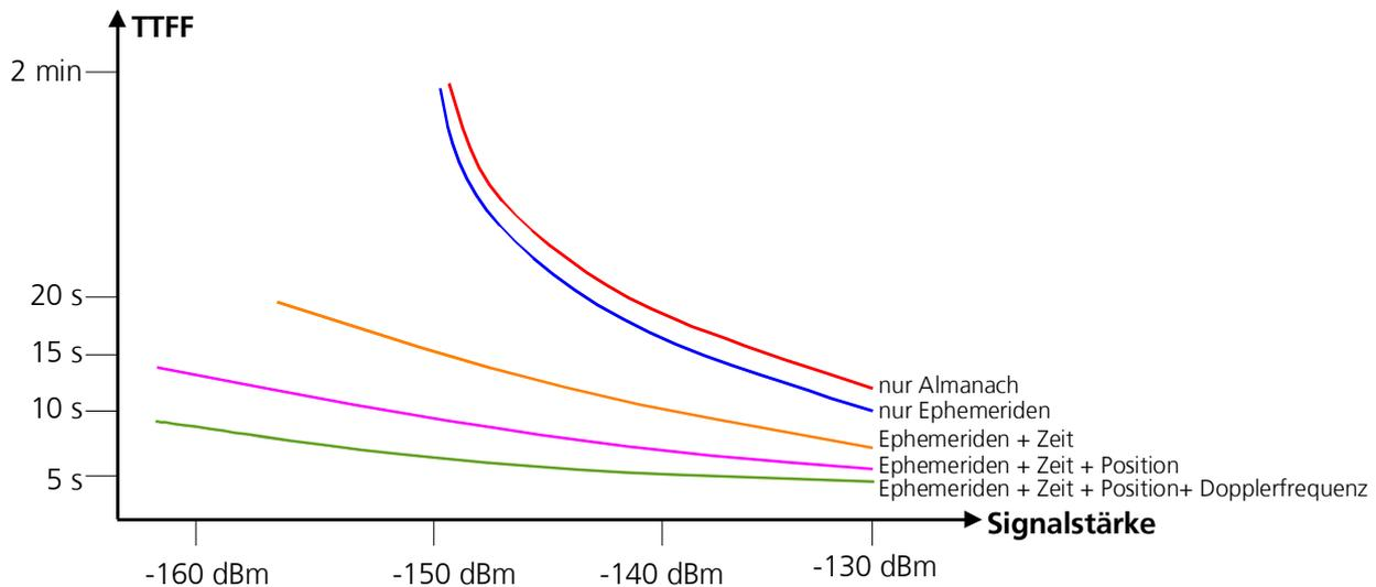
**Bild 121: Verlauf der Aufstartzeit (TTFF) bei verschiedenen Hilfsdaten und in Funktion der Signalstärke**
