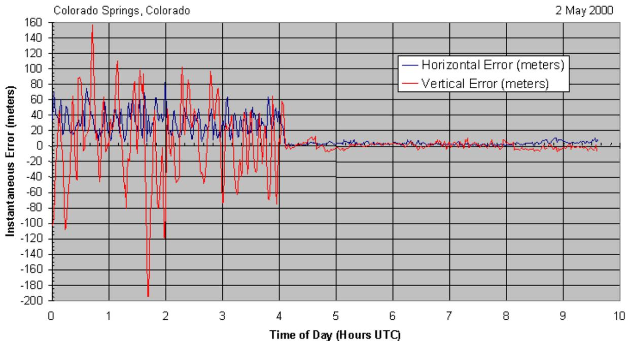
**Bild 46: Verbesserung der Positionierungsgenauigkeit in Funktion der Zeit**
