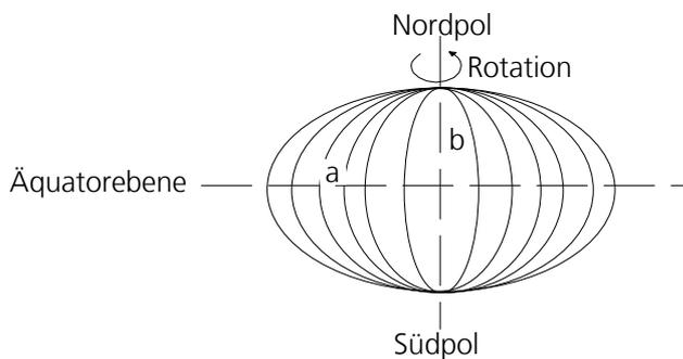
**Bild 12: Entstehung des Rotationsellipsoids**
