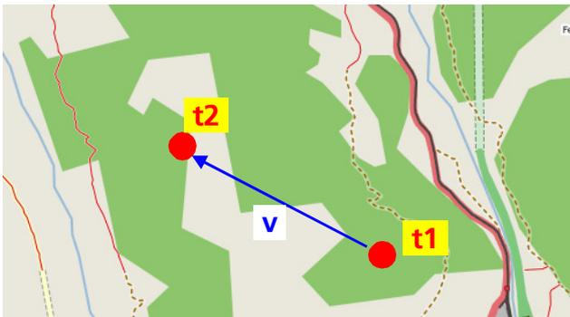
**Bild 98: Bestimmung der Geschwindigkeit durch Auswertung der Positionsveränderung**
