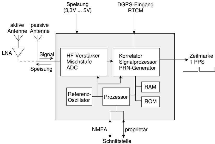
**Bild 153: Typisches Blockschema eines GPS-Moduls**
