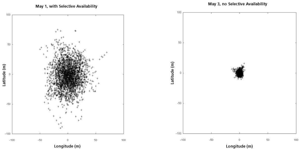
**Bild 45: Verbesserung der Positionierungsgenauigkeit nach Abschaltung der SA am 2. Mai 2002**
