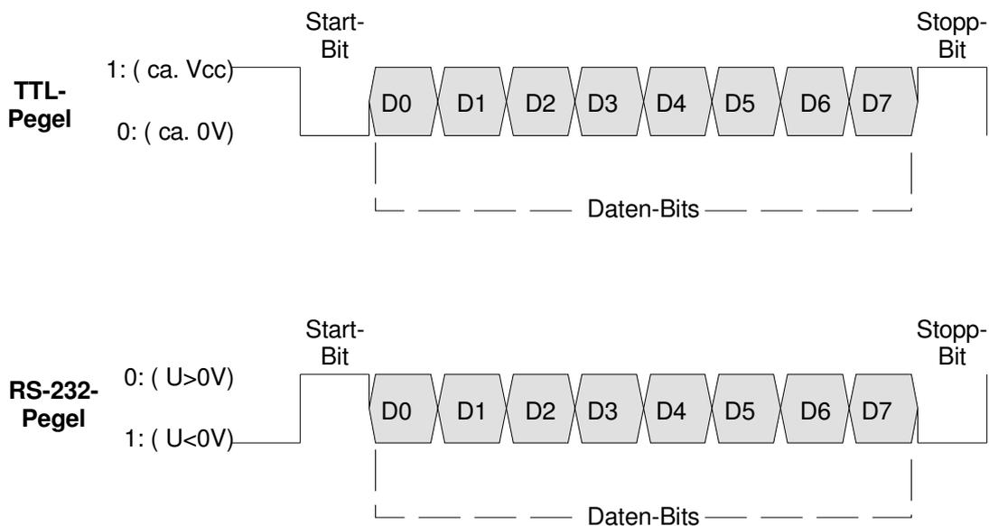
**Bild 149: Unterschied zwischen TTL- und RS-232-Pegel**
