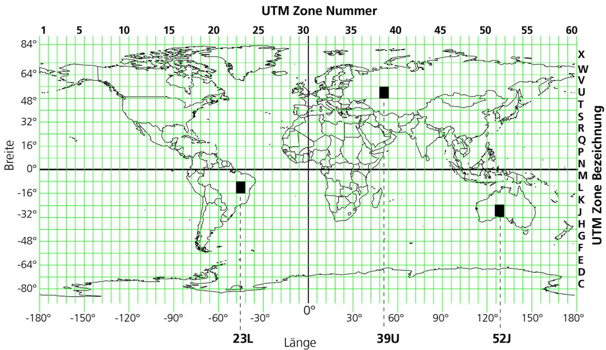
**Bild 21: Bezeichnung der Zonen bei UTM, mit Beispiele**
