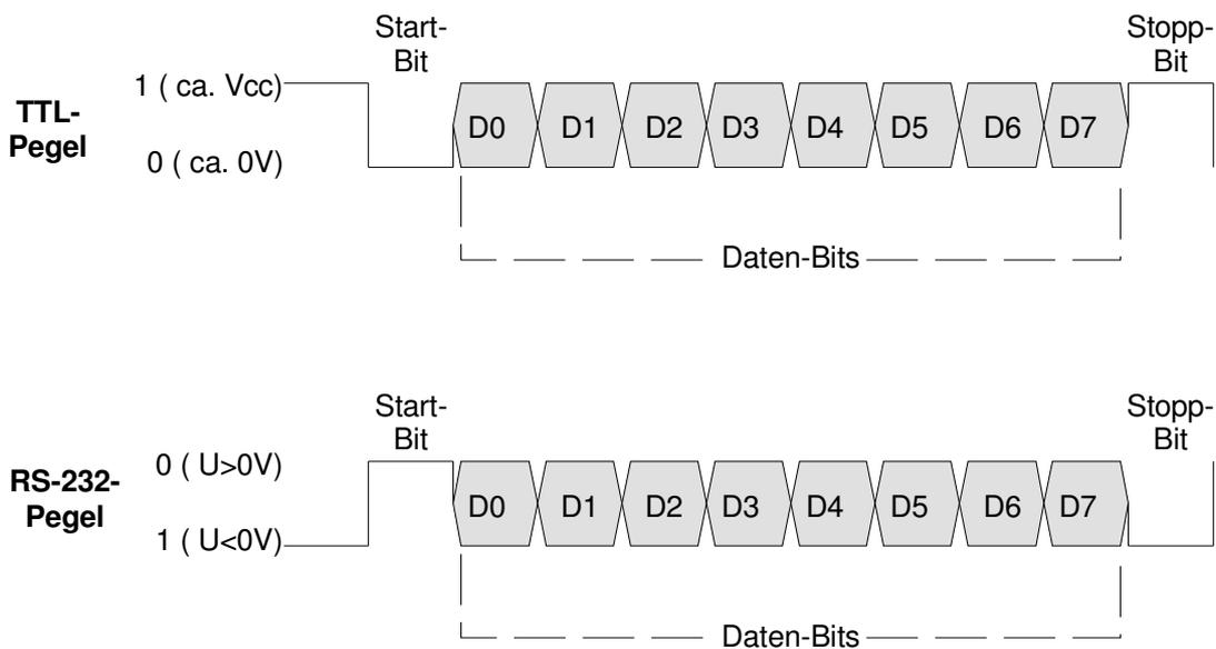
**Bild 133: NMEA-Format (TTL- und RS-232-Pegel)**
