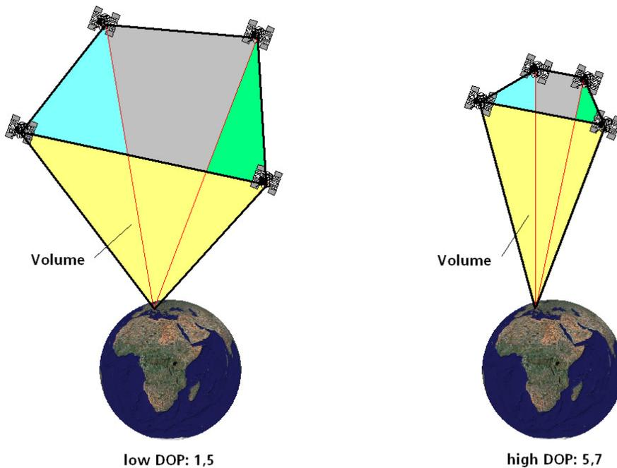
**Bild 91:** Je grösser das eingeschlossene Volumen ist ,umso kleiner ist der DOP-Wert
