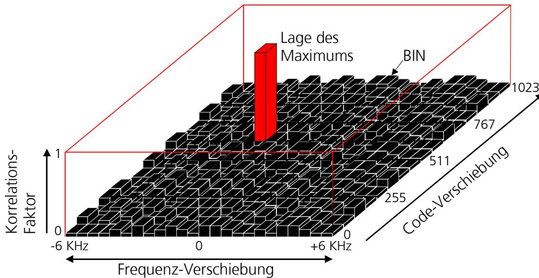
**Bild 49: Suchen des Korrelationsmaximums in der Code-Frequenzebene**
