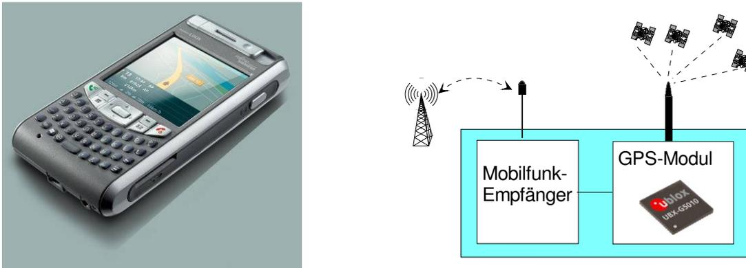
**Bild 120: Mobilfunkempfänger und Blockscha mit integriertem GPS-Modul**
