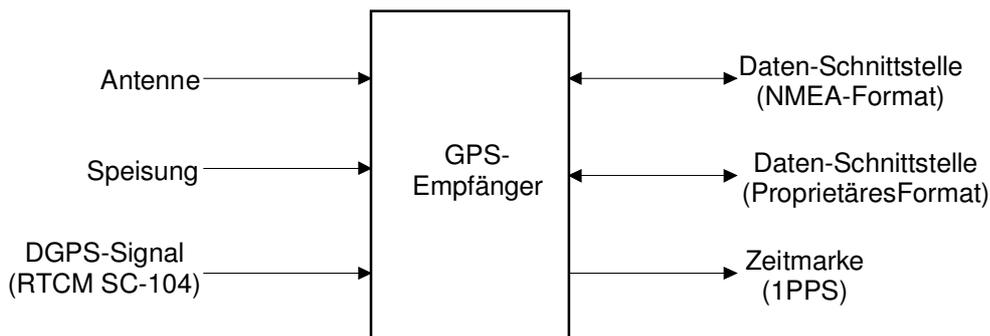
**Bild 132:** Blockschaltbild eines GPS-Empfängers mit Schnittstellen
