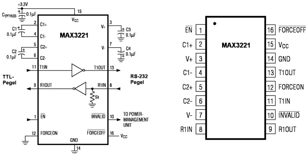
**Bild 150: Blockschaltbild und Pin-Belegung des Pegelconverters MAX3221**
