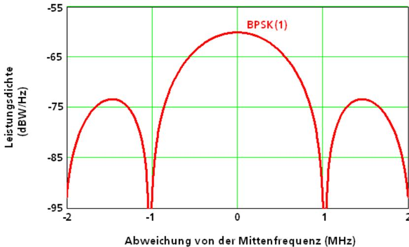
Bild 59: Leistungsdichte des BPSK(1)-Signals (Sendeleistung normiert auf 1 W)
