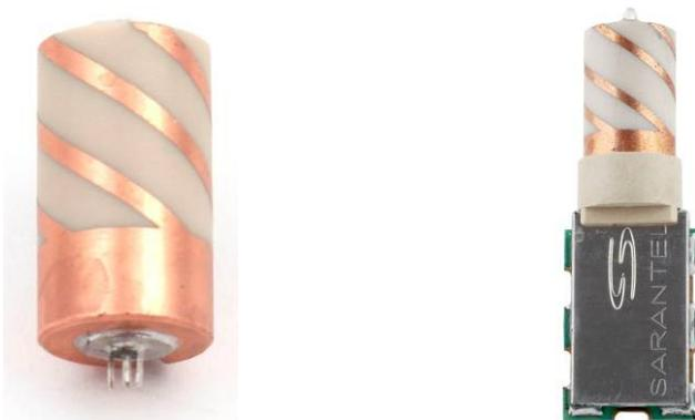
**Bild 146: Passive (links) und aktive Helix-Antenne**
