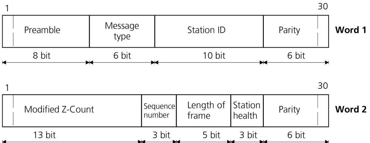
**Bild 141: Aufbau des RTCM-Nachrichtenkopfes**
