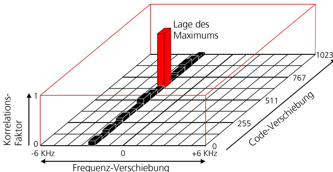
**Bild 122: Beschleunigung des Suchvorganges bei A-GPS durch Reduzierung der Suchpositionen**
