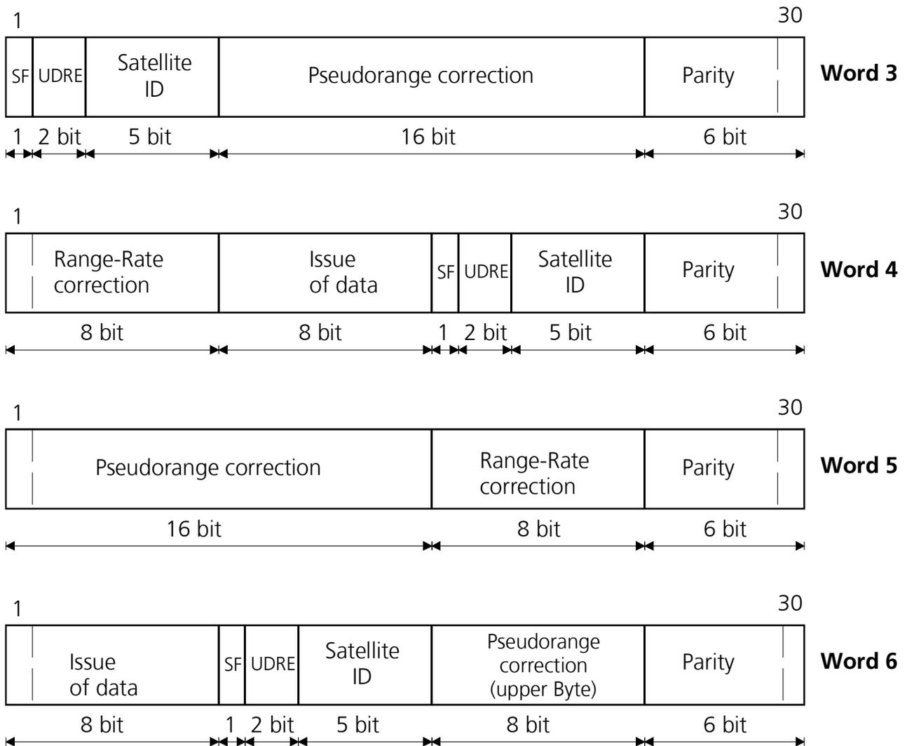
**Bild 143: Aufbau des RTCM-Nachrichtentyps 1**
