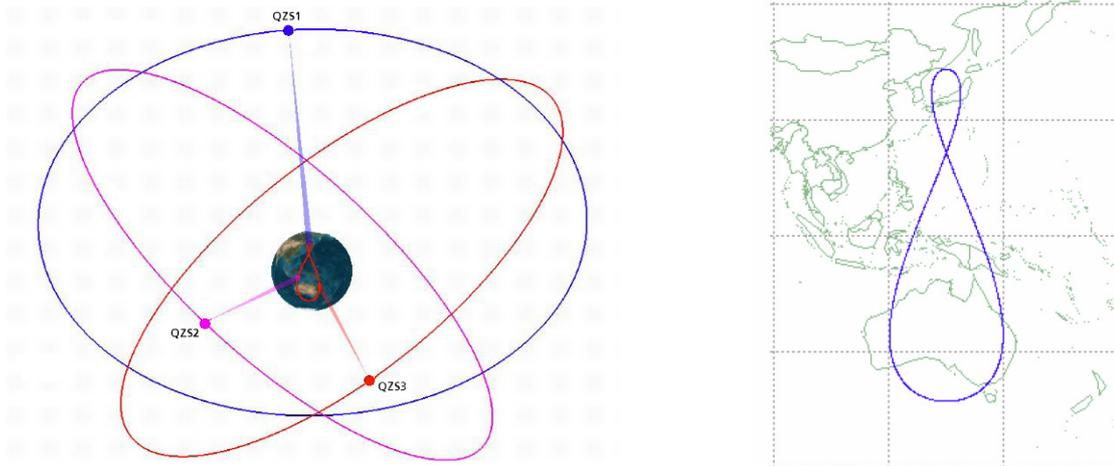
**Bild 116: Satellitenbahnen und Bodenspur von QZSS**
