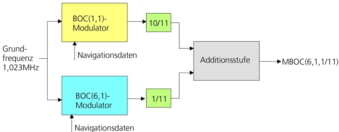
Bild 62: MBOC(6,1,1/11)-Modulators für L1C und L1 OS
