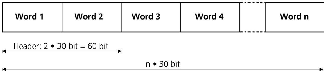
**Bild 142: Gesamtrahmen bei RTCM SC-104 bei Version 2.x**
