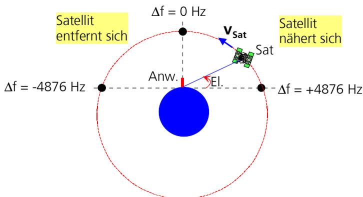
Bild 101: Verlauf der Dopplereffrequenz
