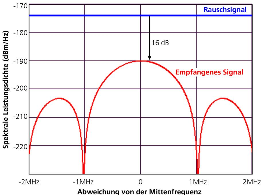
**Bild 40: Spektrale Leistungsdichte des Empfangssignals und des Rauschsignals**
