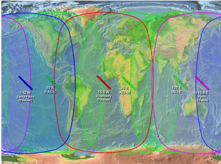
Bild 114: Ausleuchtzone von Starfire
