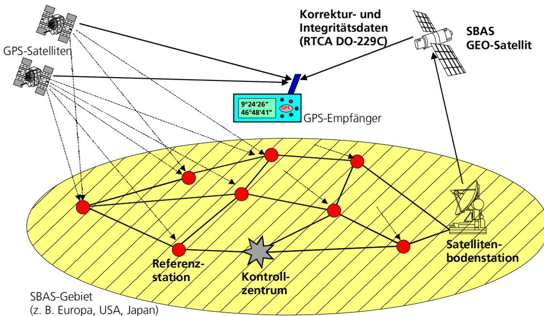
Bild 119: Prinzip aller satellitengestützte Erweiterungssysteme SBAS
