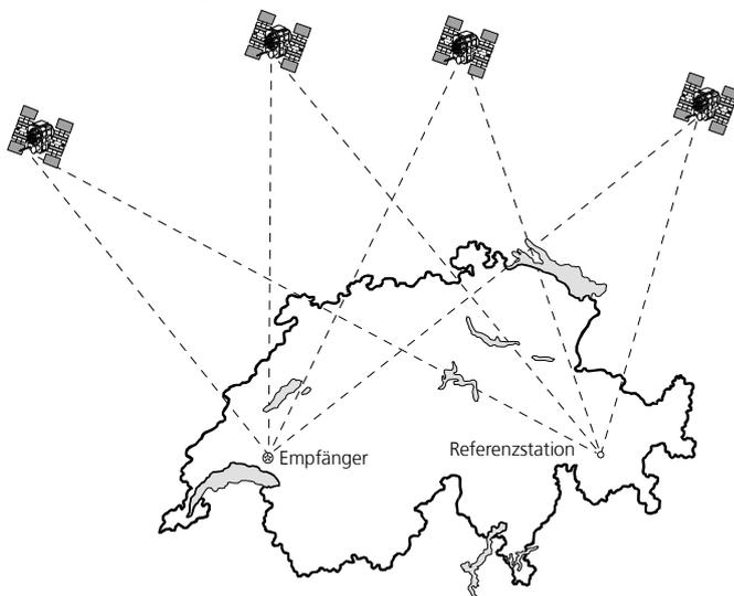
**Bild 106: Prinzip des DGPS mit einer GPS-Referenz-Station**
