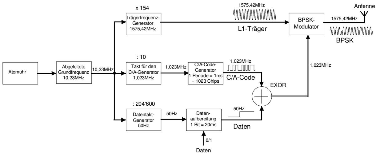
**Bild 44: Detailliertes Blockschemata eines GPS-Satelliten**
