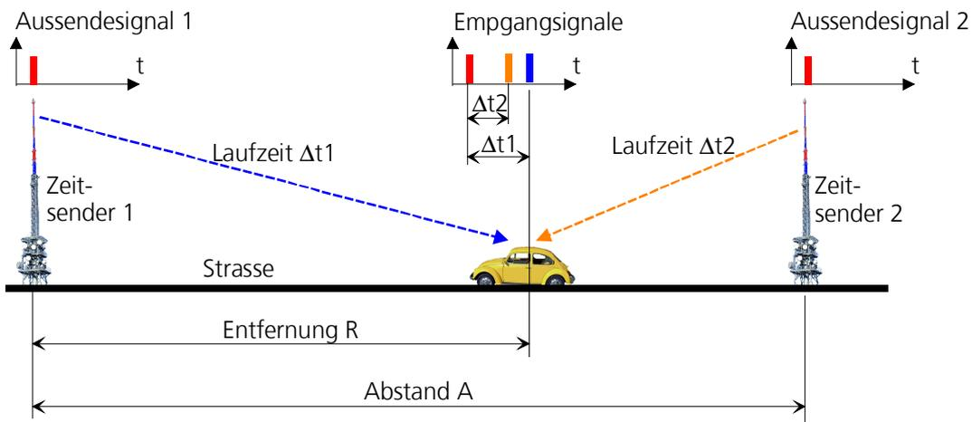
**Bild 4: Mit zwei Sendern kann die exakte Position R, trotz Zeitfehler  $\Delta t_0$ , bestimmt werden**
