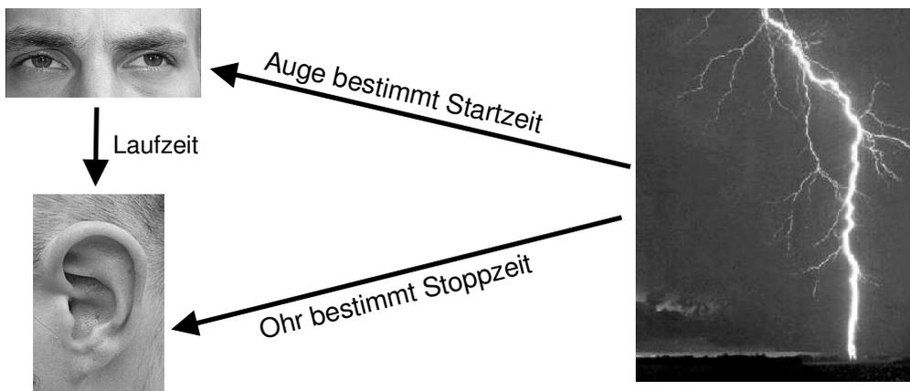
**Bild 2: Bestimmung der Entfernung zu einem Blitz**
