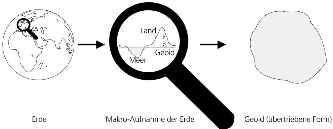
**Bild 11: Das Geoid als Annäherung der Erdoberfläche**
