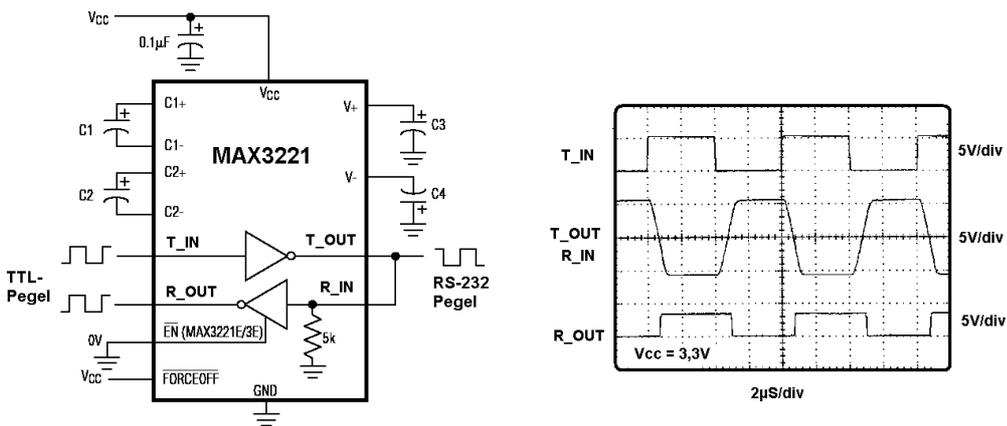
**Bild 151: Funktionstest des Pegelconverters MAX3221**
