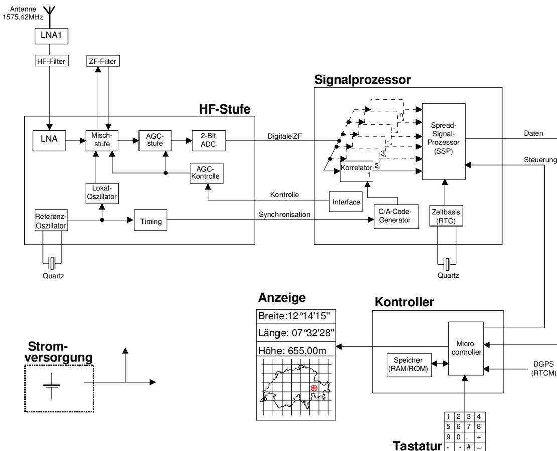
Bild 152: Vereinfachtes Blockscha eines GPS-Empfängers
