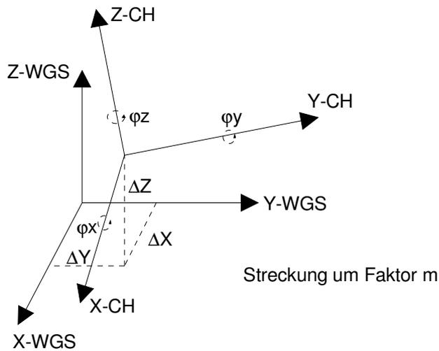
**Bild 17: Geodätisches Datum**
