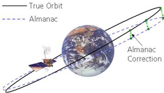
**Bild 126: Aus den Almanach-Daten werden präzise Bahndaten (True Orbit) vorausberechnet**
