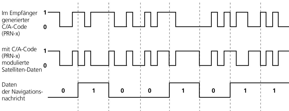
**Bild 86: Rekonstruktion der Navigationsnachricht**
