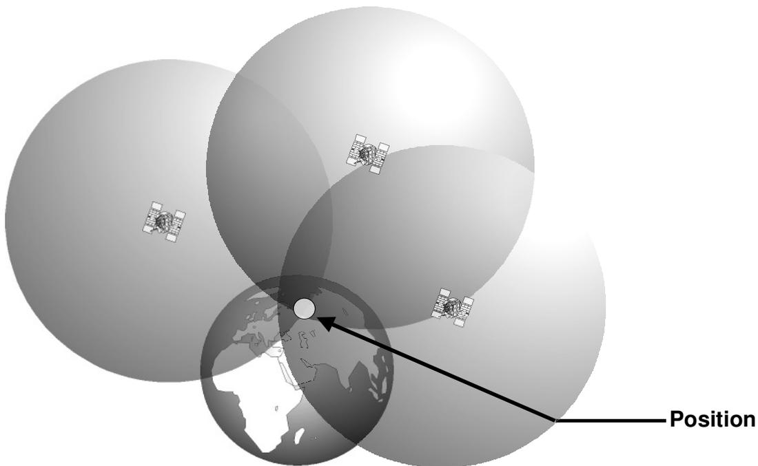
**Bild 9: Der Schnittpunkt dreier Kugeln bestimmt die Position**
