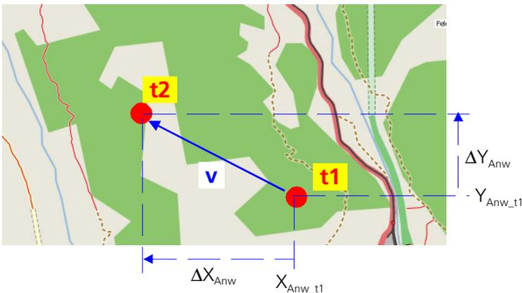
**Bild 99: Bezeichnung der Verschiebung in einer Ebene**
