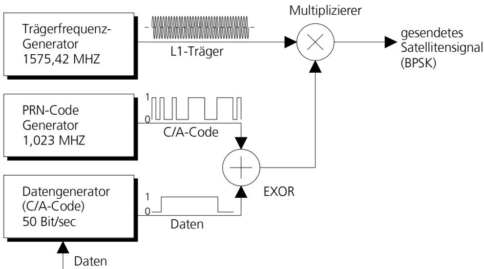
**Bild 42: Vereinfachtes Satellitenblöckschema**
