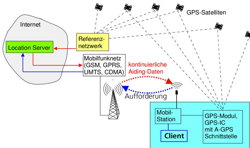
**Bild 125: Bei online A-GPS werden die Hilfsdaten kontinuierlich übertragen**
