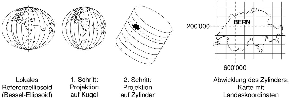
**Bild 23: Prinzip der Doppelprojektion**
