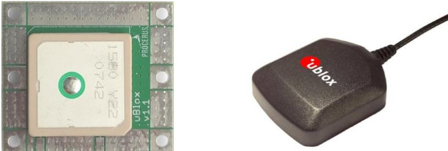
**Bild 145: passive offene (links) und aktive vergossene Patch-Antenne**
