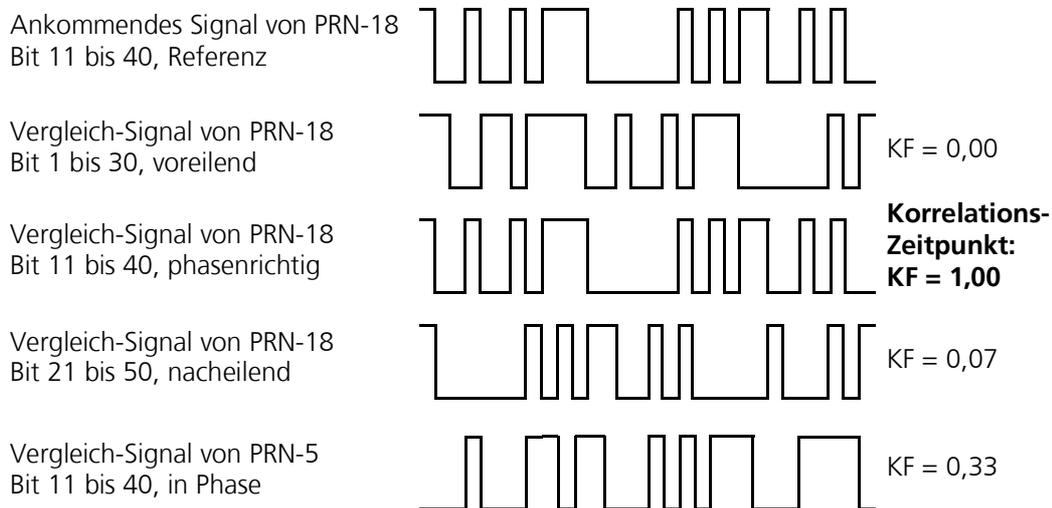
**Bild 48: Demonstration des Korrelationsvorgangs über 30 Bits**
