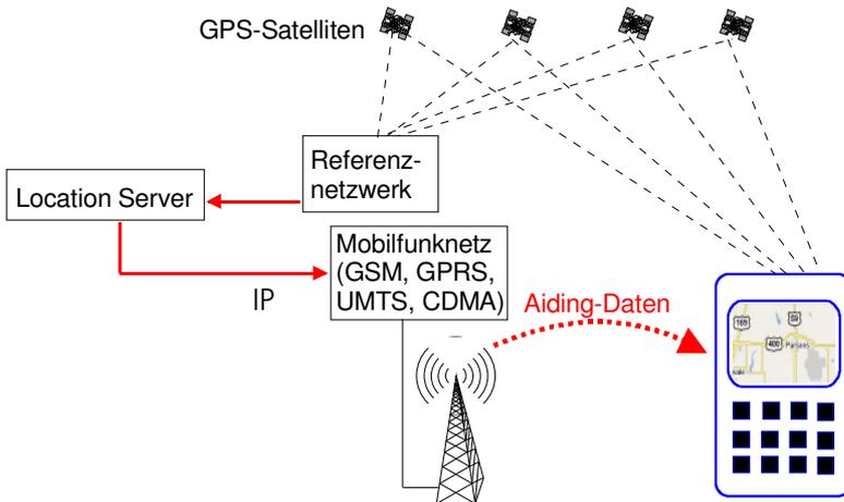
**Bild 128:** Bei der User-Plane Architektur muss das Mobilfunknetz nicht geändert werden.
