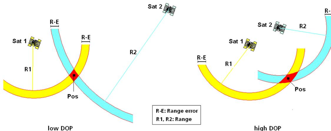
**Bild 90:** Je flacher sich die Kreisringe schneiden, umso grösser ist der DOP-Wert
