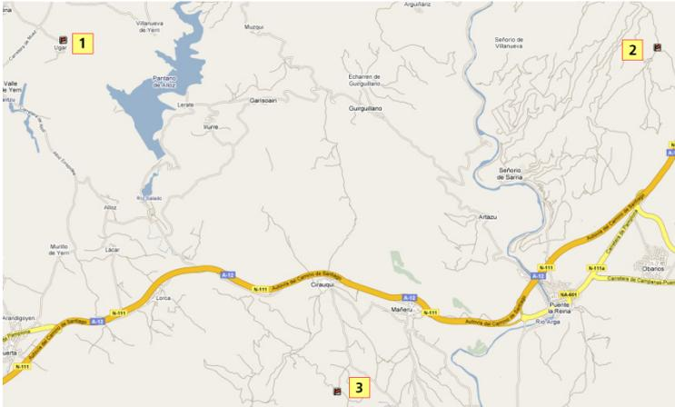
**Bild 28: Rasterkarte mit drei Kalibrationspunkten [vii]**
