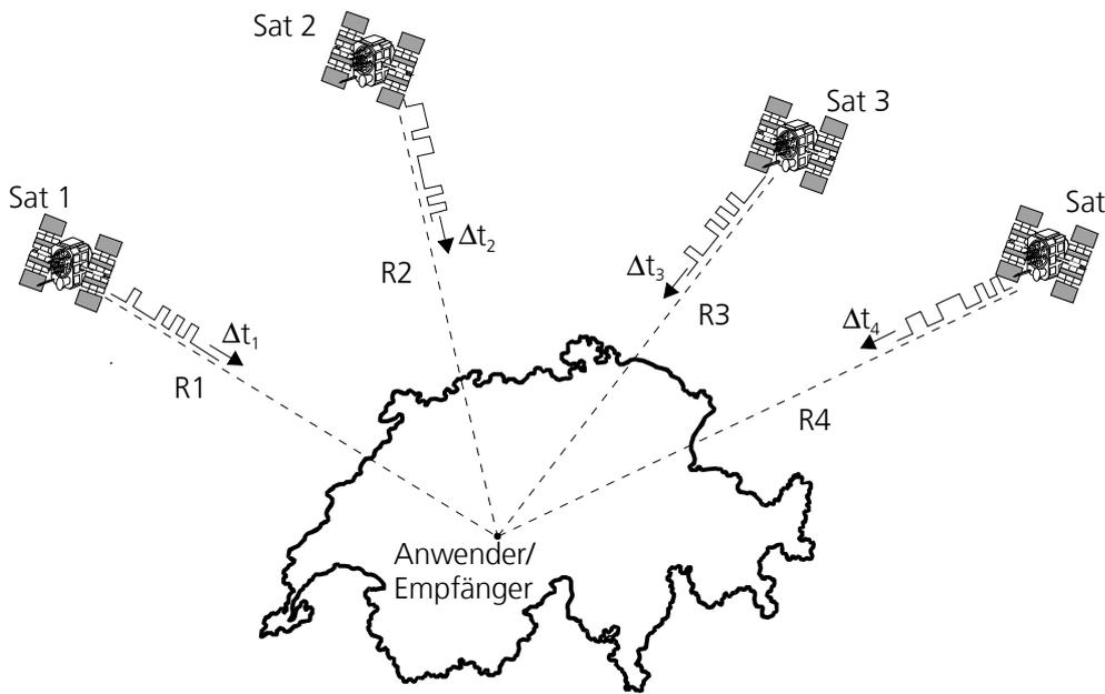
**Bild 79: Vier Satellitensignale müssen empfangen werden**
