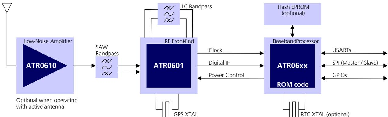
**Bild 154: Blockschema mit ANTARIS®4 Chipsatz**
