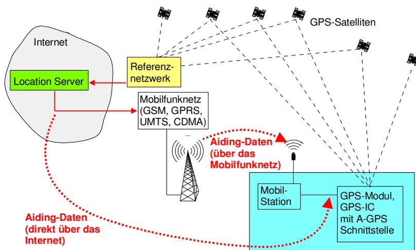
**Bild 124: Assisted-GPS Gesamtsystem**
