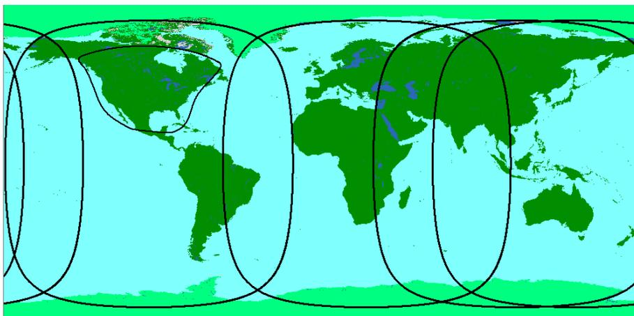
**Bild 113: Ausleuchtezone der 6 Omnistar-Satelliten (zwei Bereiche überdecken sich)**
