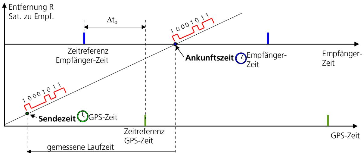
Bild 88: Bestimmung der fehlerbehaftete Laufzeit
