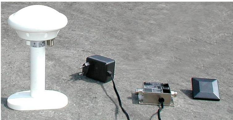
**Bild 131: GPS-Repeater (Aussenantenne, Netzteil, Verstärker und Innenantenne)**
