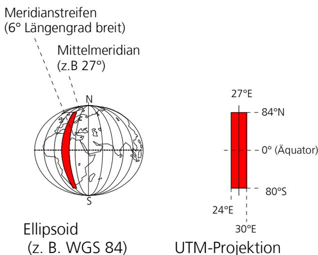
**Bild 20: Prinzip der Abbildung einer (von sechzig) Zone**
