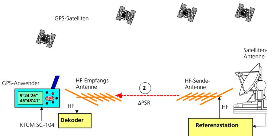
**Bild 108: Übermittlung der Korrekturgrößen**
