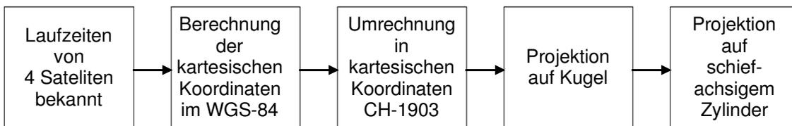
**Bild 24: Vom Satelliten bis zur Position**
